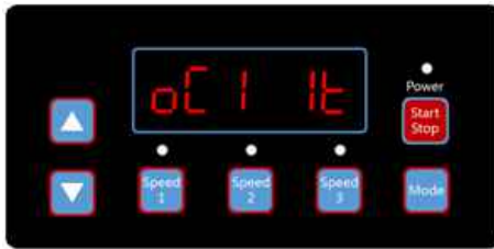
(Diagram 6.25, Auto Recovery, error details OC1, error time 1) (图6.25, 自动复位/启动, 错误信息OC1, 错误次数1次)
